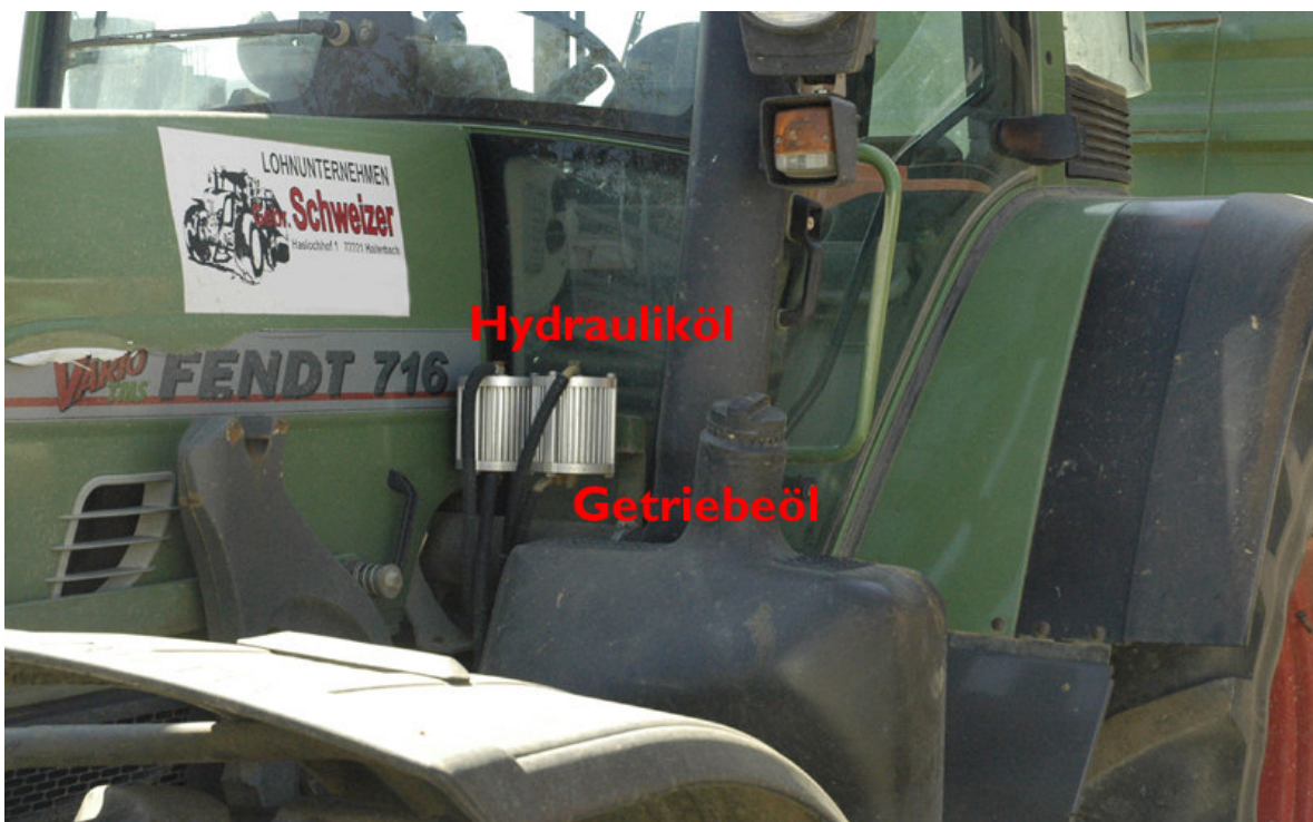
Filter für den Hydraulik-Kreislauf (bis 20 bar ohne Druckminderung) und für den Getriebe-Kreislauf
