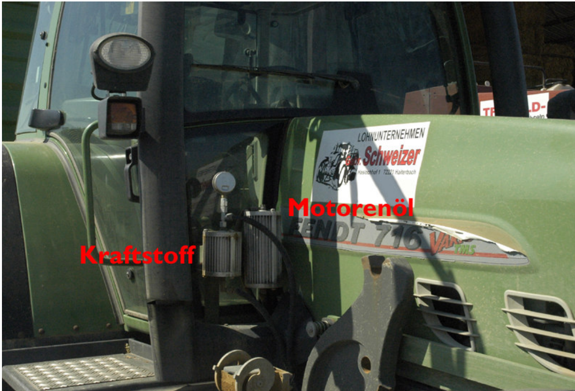
Filter mit Manometer und Bypass für Kraftstoff, Filter für die Reinhaltung des Motorenöls
