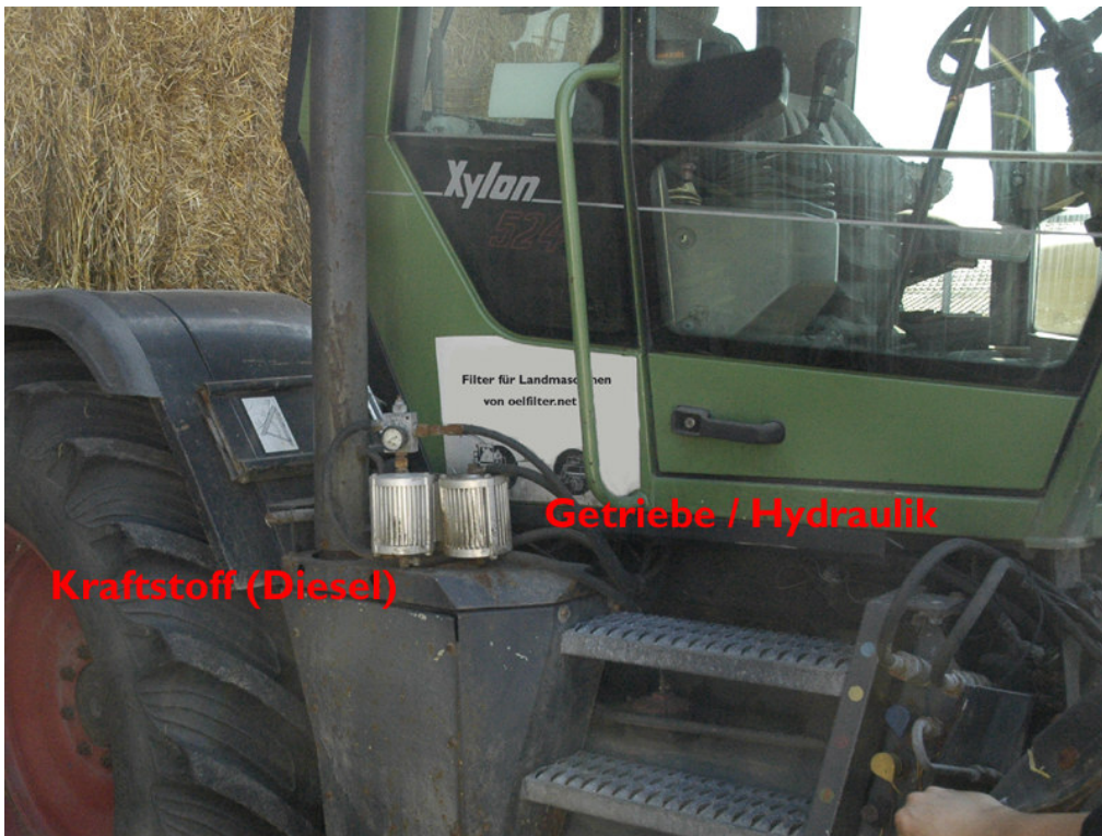
Filterung des Dieselkraftstoffs und des Hydraulik- und Getriebekreislaufes
